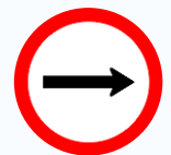
Sentido de circulação da via ou pista R-24a
